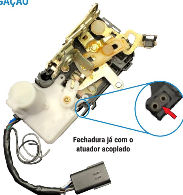
Após concluir a montagem, o produto tem dois fios, ( cinza e preto) onde deverão ser ligados na tomada do sensor de porta, conforme indicado.
