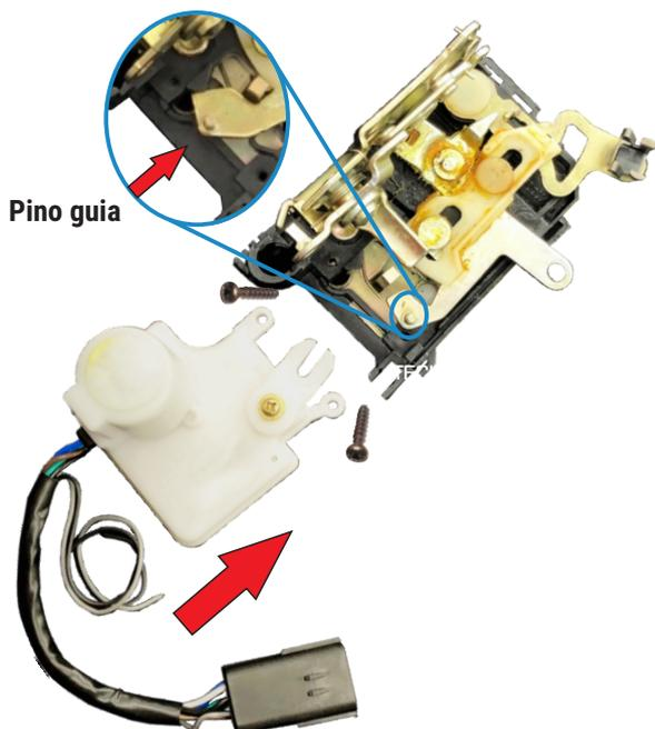
**1º** Posicionar o atuador na fechadura conforme indicado.
