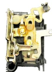
Fechadura sem a capa protetora
