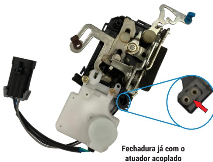
Após concluir a montagem, o produto tem dois fios, ( cinza e preto) onde deverão ser ligados na tomada do sensor de porta, conforme indicado.
