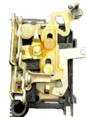
Fechadura sem a capa protetora
