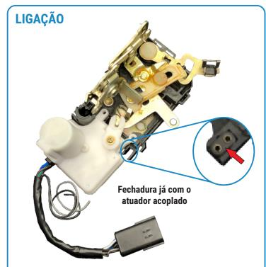
Após concluir a montagem, o produto tem dois fios, ( cinza e preto) onde deverão ser ligados na tomada do sensor de porta, conforme indicado.
